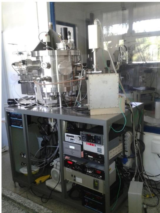
**Figura 11:** Sistema de Sputtering KJL com algumas modificações do Laboratório de Filmes Semicondutores utilizado para deposição das amostras deste trabalho.
