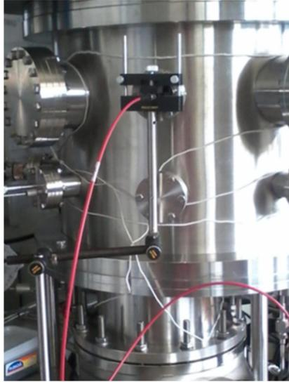
**Figura 12:** Fixação da fibra ótica na câmara de deposição para realizar os experimentos de emissão do plasma.
