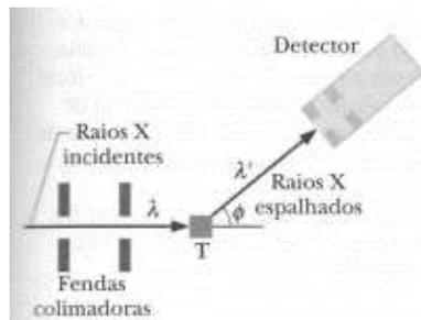
**Fig. 38-3** Montagem usada para estudar o efeito Compton. Um feixe de raios X de comprimento de onda  $\lambda = 71,1$  pm incide em um alvo de carbono T. Os raios X espalhados pelo alvo são observados em vários ângulos  $\phi$  com a direção do feixe incidente. O detector mede tanto a intensidade como o comprimento de onda dos raios X espalhados.
