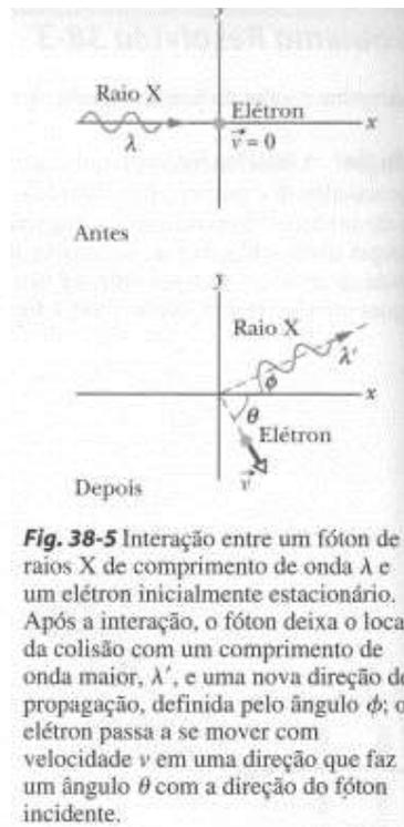
**Fig. 38-5** Interação entre um fóton de raios X de comprimento de onda  $\lambda$  e um elétron inicialmente estacionário. Após a interação, o fóton deixa o local da colisão com um comprimento de onda maior,  $\lambda'$ , e uma nova direção de propagação, definida pelo ângulo  $\phi$ ; o elétron passa a se mover com velocidade  $v$  em uma direção que faz um ângulo  $\theta$  com a direção do fóton incidente.
