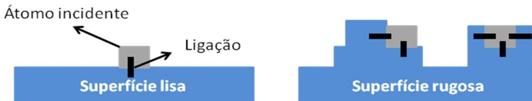
**Figura 40** Esquematização de superfícies lisas e rugosas a nível atômico. Na superfície lisa as espécies que chegam possuem menor dificuldade de desorção devido à menor quantidade de ligações disponíveis. Já em uma superfície rugosa, a incorporação de átomos se torna mais estável pela maior quantidade de ligações prováveis.
